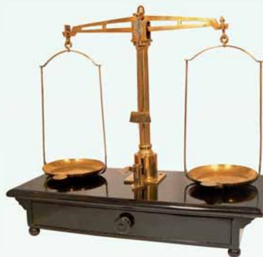
égaux à fléaux composés, en boîte fermée (balance de comptoir de prestige, avec index en flèches engagées dans une pendule) ou simplifiée ouverte (marchés). D'une portée de 1 à 100 kg, elle est répandue en Europe (photo 3, p.13).
